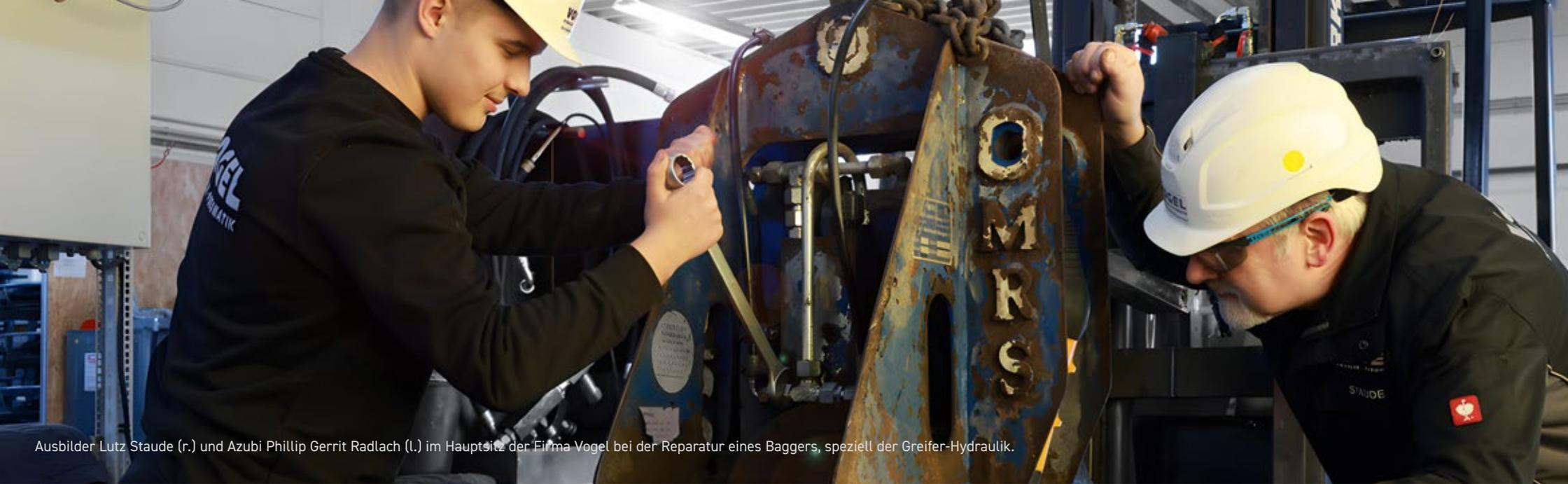
Ausbilder Lutz Staudé (r.) und Azubi Phillip Gerrit Radlach (l.) im Hauptsitz der Firma Vogel bei der Reparatur eines Baggers, speziell der Greifer-Hydraulik.
